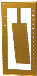
Abbildung 2: Aufbau Neigungssensoren KAS
