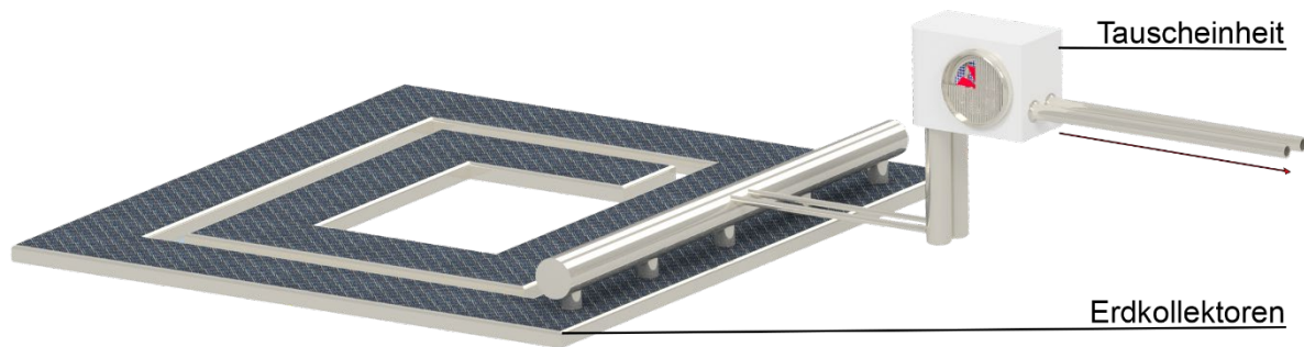
Abbildung 4 WP mit erdnahen Kollektoren
